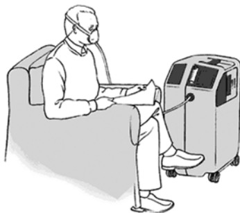
Koncentrator tlenowy zagęszcza tlen z powietrza, dzięki czemu nie trzeba dostarczać do domu ciężkich butli z tlenem
